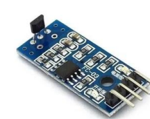
Módulo Medición de Velocidad / Efecto Hall
